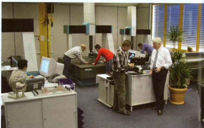
Dank offener Schnittstellen im „Trendows-Xp“ können weitere Messmaschinen für die Lohnmesstechnik zertifiziert und in das Raumklima-Online-Monitoring eingebunden werden
