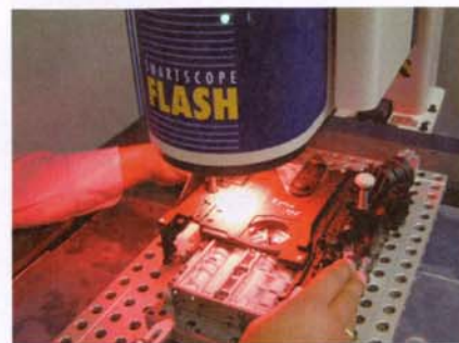
Bestückung zur optischen Messung von Formteilen auf einer OGP «Smartscope Flash 400».
