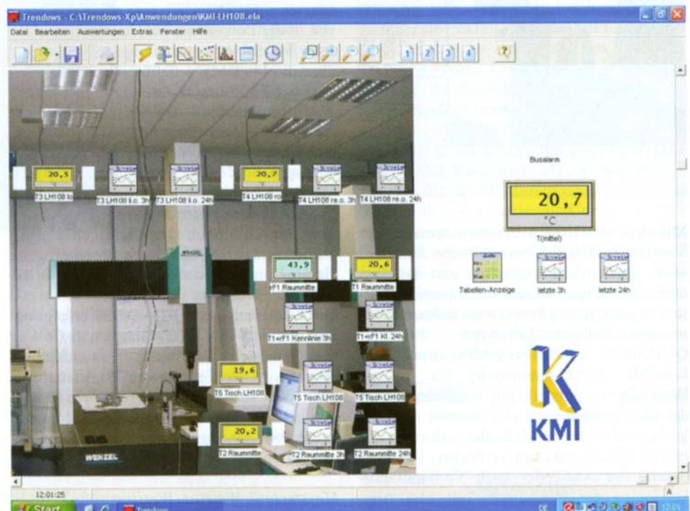
Einfache Visualisierung mit Foto als Hintergrundbild und einer Übersicht der Messstellen.
