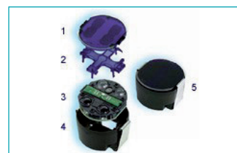
Bild 1: Aufbau eines Regensensors
