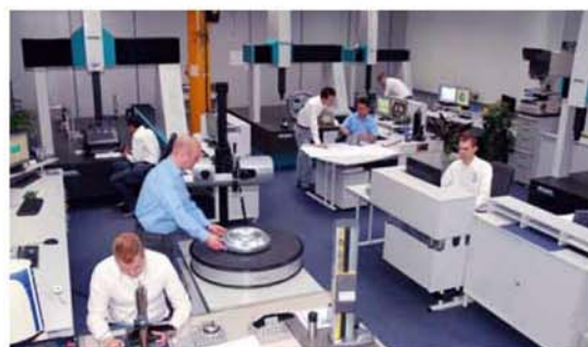
Das KMI ist mit einem mehr als 200 Quadratmeter großen vollklimatisierten Messlabor und hochwertigen 3D-Koordinatenmessgeräten ausgestattet.
