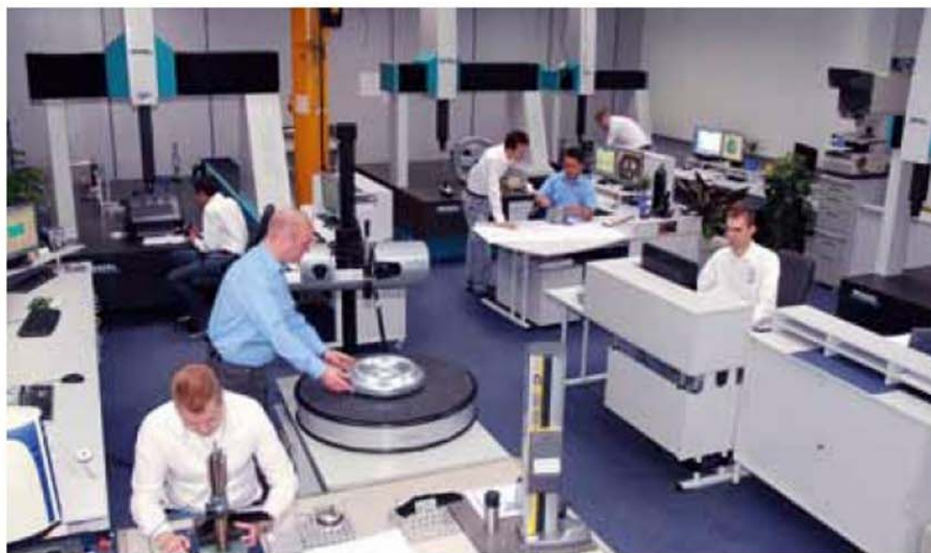
Das KMI ist mit einem mehr als 200 Quadratmeter großen vollklimatisierten Messlabor und hochwertigen 3D-Koordinatenmessgeräten ausgestattet.
